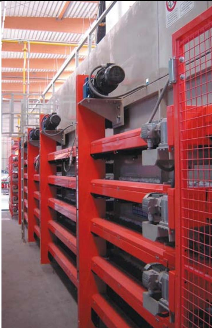
La trasmissione di moto ai rulli avviene per mezzo di coppie di ruote a denti elicoidali in carter chiuso, con lubrificazione a bagno d'olio. Questo accorgimento fa sì che tutte le macchine siano estremamente affidabili e praticamente esenti da manutenzioni.
