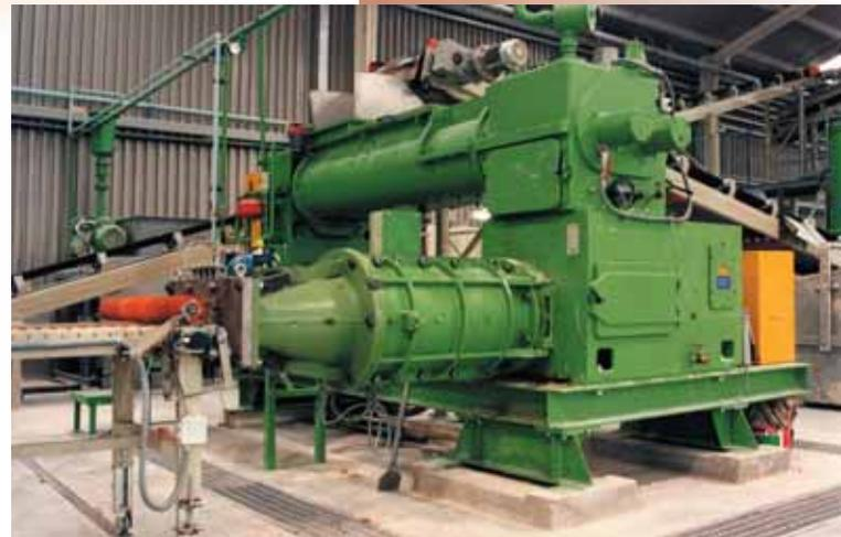
La fase di formatura avviene con estrusori operanti sotto vuoto particolarmente studiati per l'estrusione in piano anche di formati molto grandi (600x600, 600x900) e di piccolo spessore (6-12 mm). Tutte le attrezzature (coni di estrusione e stampi) sono state studiate appositamente.
