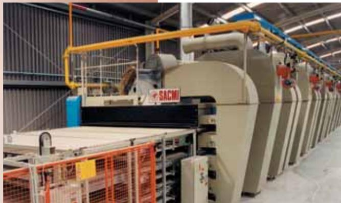
L'essiccatoio orizzontale a rulli a 4 piani E4P è la macchina più innovativa di tutta la linea. Siamo riusciti ad ottenere cicli di essiccazione di 50'-120'.
