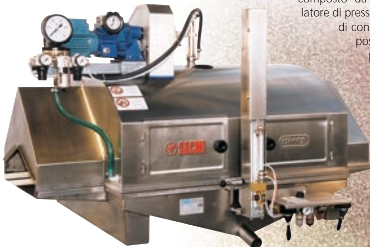
**Cabina di fiammatura** Risulta un dispositivo per la nebulizzazione degli smalti completo di aerografo, eventualmente anche mobile. Il gruppo è composto da un involucro in acciaio inox con prese di aspirazione, regolatore di pressione doppio con relativo impianto pneumatico, manometro di controllo erogazione smalto, aerografo a bassa pressione, dispositivo pneumatico per l'apertura automatica della cabina, prefiltrato per il recupero dello smalto in aspirazione, serran-
