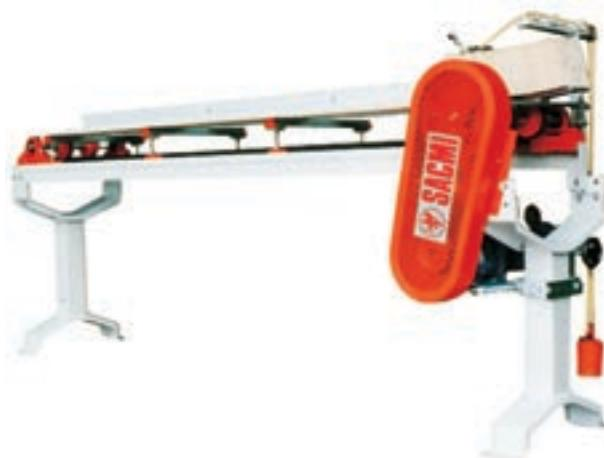
**Alimentatore manuale piastrelle** Nel caso della bicottura le piastrelle possono essere alimentate manualmente con cadenza regolabile all'inizio della linea di smaltatura.
