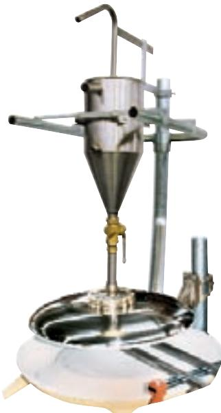
**Dispositivo a campana** Risulta il dispositivo di applicazione dello smalto più idoneo per ottenere superfici lisce e brillanti, sia nel caso della bicottura che monocottura, anche se il suo utilizzo è prevalente nel caso della monoporosa e bicottura.
